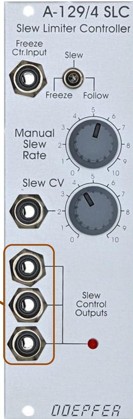
Die **Slew Control Outputs** (3 Buchsen) dienen zum Anschluss von bis zu 3 A-129 / 3 Slew Limitern, die dann vom A-129 / 4 zentral gesteuert werden können. Eine LED daneben zeigt die Aktivität des Moduls an.
