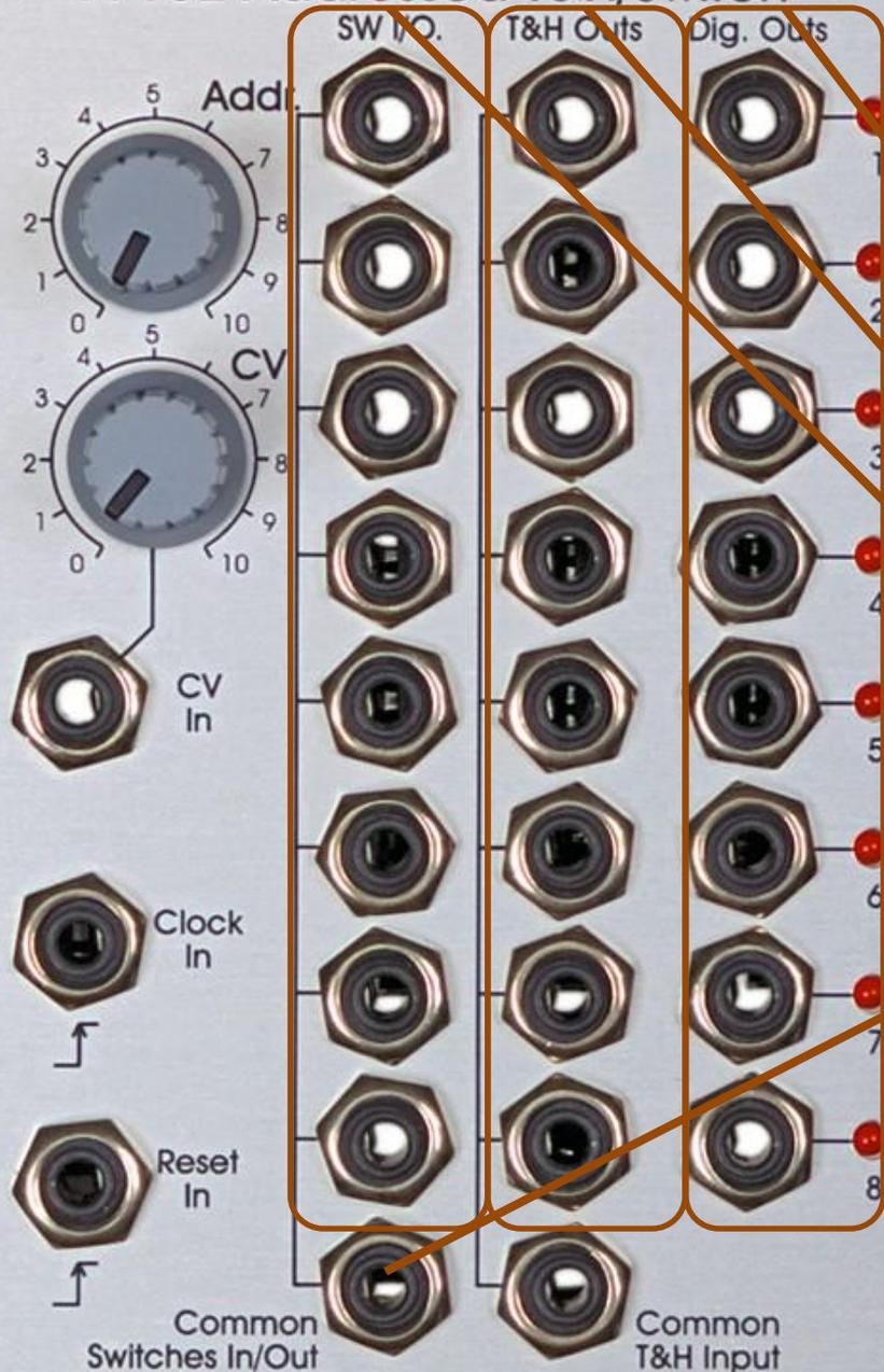
**Dig Outs 1 bis 8:** Gate-Ausgänge, die bei aktiver Stufe ein Gatesignal ausgeben, bei inaktiver Stufe 0V.
